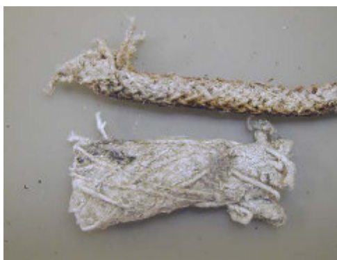
Cordon d'amiante utilisé comme joint de protection contre le feu
