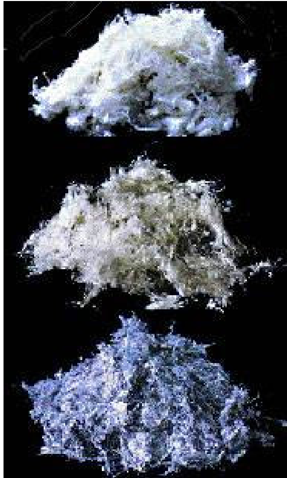
Amiante blanc (chrysotile)
