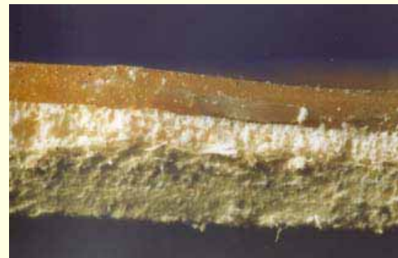
In Bahnen verlegter Bodenbelag im Querschnitt; unterste Schicht aus Asbestkarton
